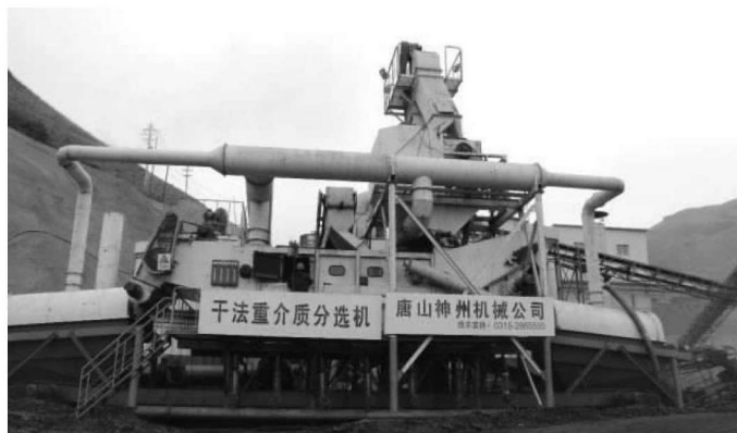
图7 模块式干法重介质流化床选煤厂
