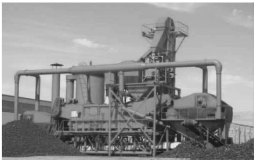
图3 干法重介质流化床工业示范系统
